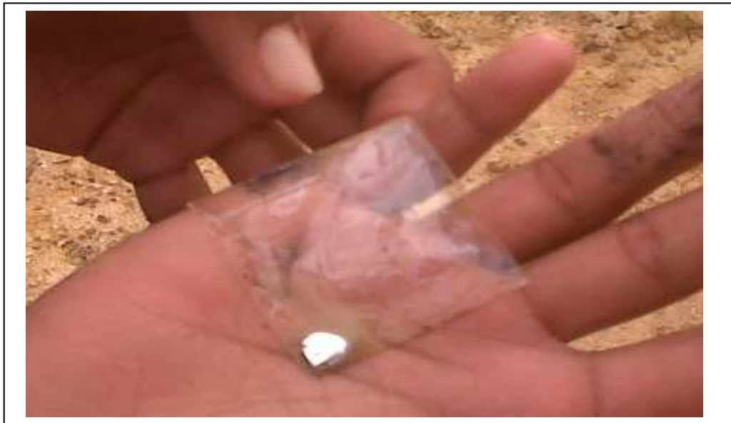
Gambar 15. Raksa yang digunakan pekerja tambang emas dalam proses penambangan
