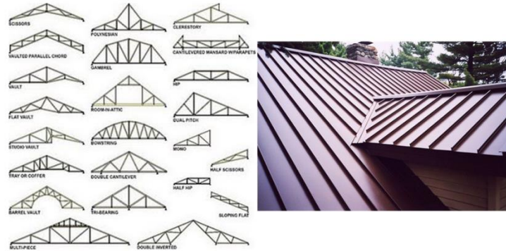
Gambar 4.29. Jenis Struktur Rangka Baja (kiri) dan Jenis Atap Metal (kanan). Sumber: Jayawan, 2014 dan 99.co, 2019.
