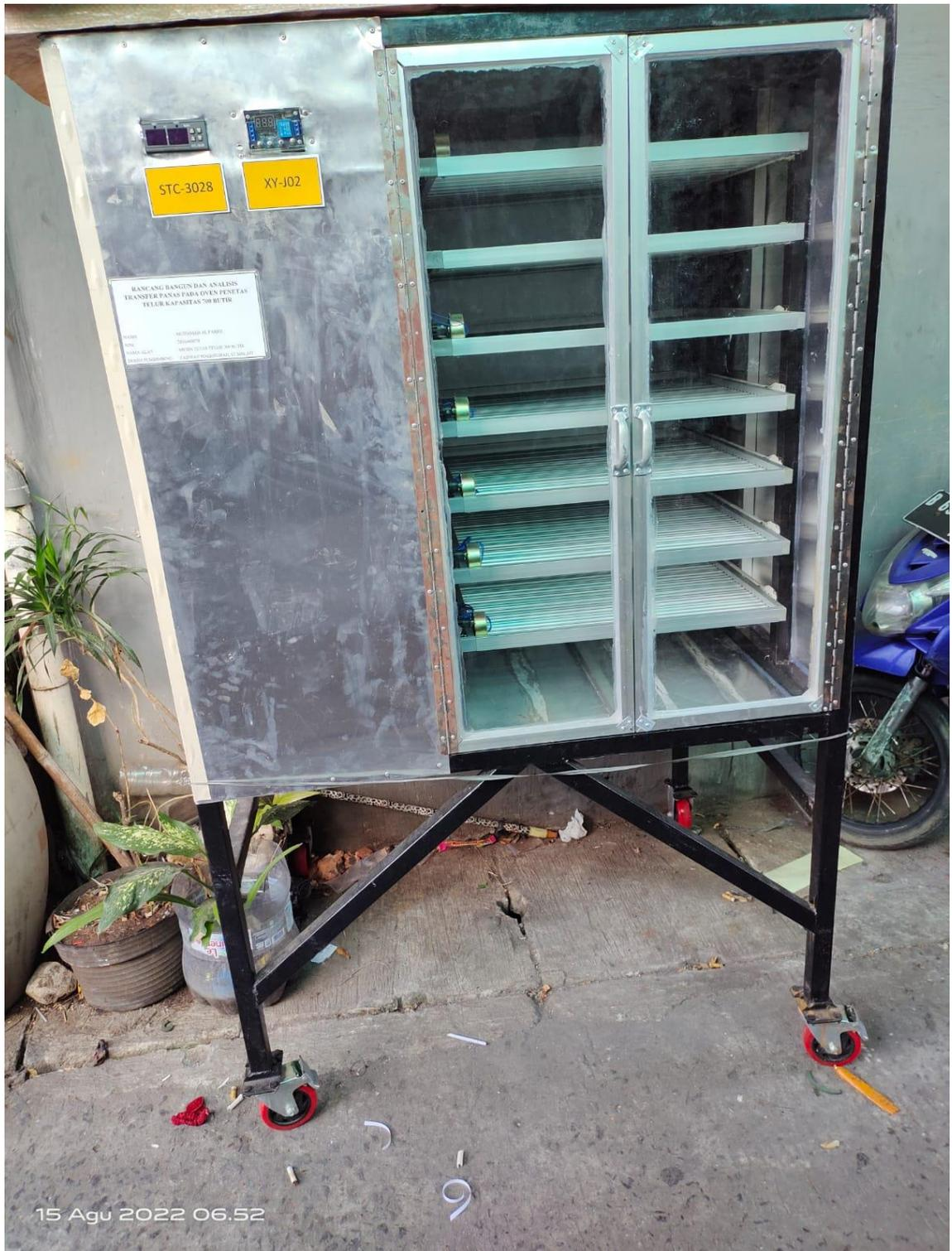
Gambar 4. Unit Penetas Telur Kapasitas 100 - 150 butir
