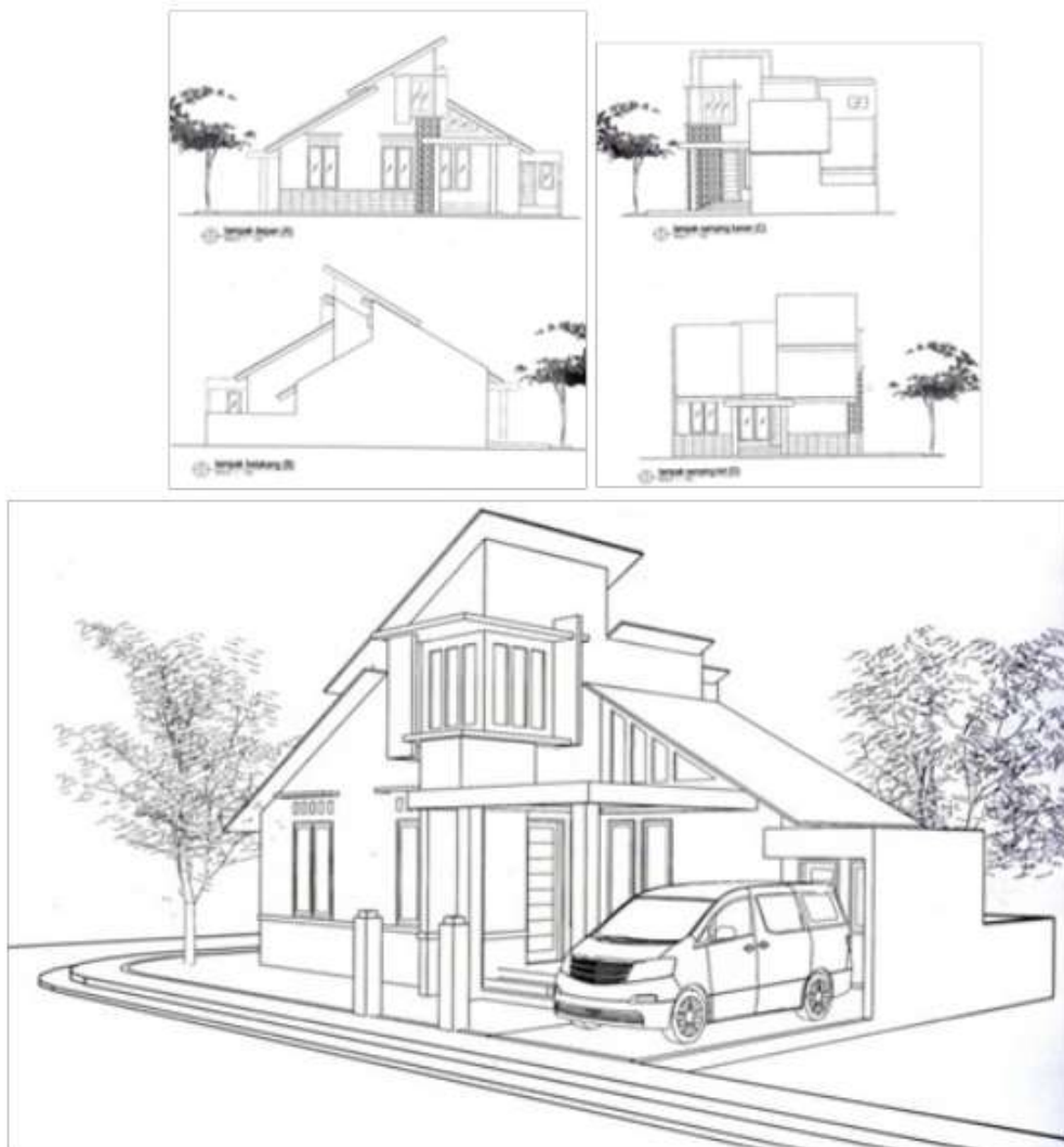
Gambar 5.13. Gambar Perspektif Manual, Proporsional dengan Gambar Tampak Bangunan, oleh Nur 2009 (Sumber: Pribadi)
