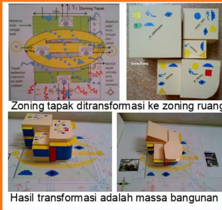
Gambar 3.18. Transformasi Zoning Tapak ke Zoning Ruang untuk Menghasilkan Massa Bangunan (Sumber: pribadi)
