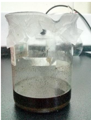
Lampiran 4. Proses Pelarutan dan Maserasi Daun Kumis Kucing
