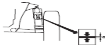
Gambar. 10 level “a” pada suspense
