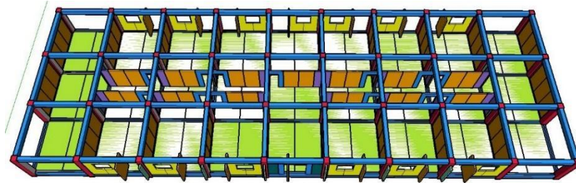
Gambar 14. Penempatan Dinding Bangunan yang Dibuat Dengan Metode Konvensional Sumber: Peneliti, 2020
