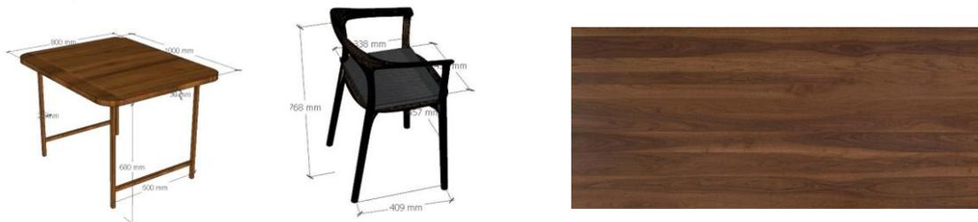
**Gambar 8.** Ukuran dan Material yang digunakan pada *furniture* restoran
