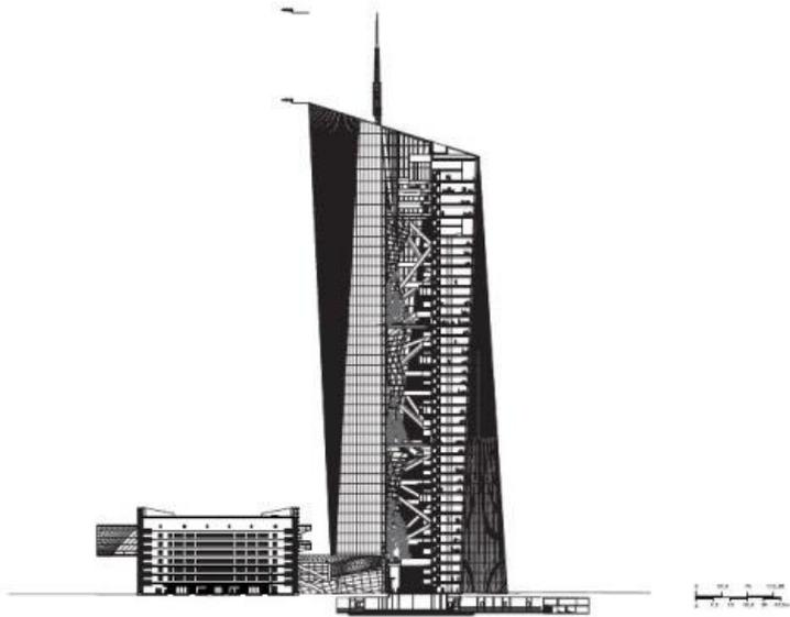
**Gambar 7.47** Gambar Potongan Bangunan *European Central Bank*.
