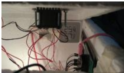
Gambar 15 Pengukuran suhu Dc cooler pada lampu 5 watt dengan hygro termo digital.
