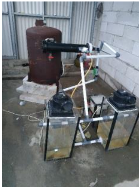
Gambar 1.4. Alat pengolah sampah metode pirolisis
