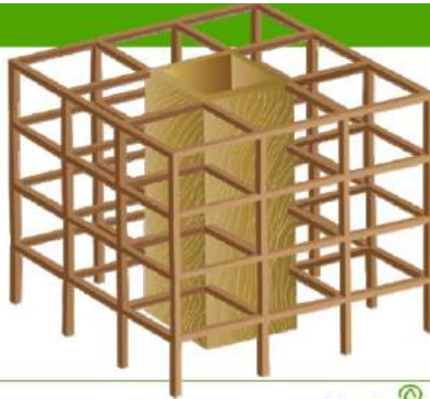
Gambar 34. Struktur bangunan kayu dengan konstruksi dinding geser untuk apartemen perumahan di United Kingdom dan Swedia, (Sumber:Tjondro, 2014)
