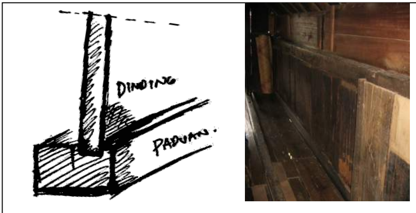
Gambar 58. Dinding bagian dalam rumah (Sumber: Dokumentasi Pribadi, 2014)
