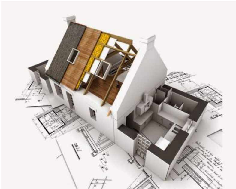
Gambar 3. Sistem selubung pada bangunan (Sumber: www.kampus-sipil.com )
