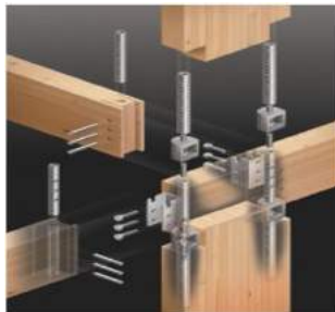
Gambar 32. Contoh sambungan kayu (Sumber: Tjondro, 2014)
