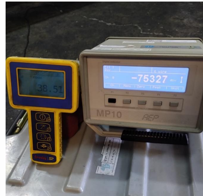
Gambar 3.8: Contoh kasus pengambilan data kalibrasi UTM menggunakan metode 3
