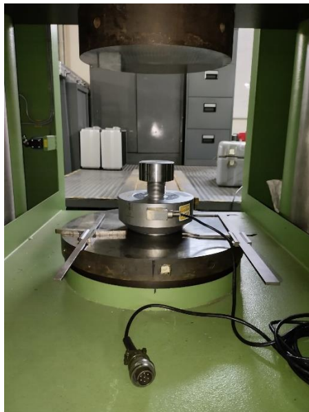
Gambar 3.1: Pengaturan letak alat ukur gaya arah tekan
