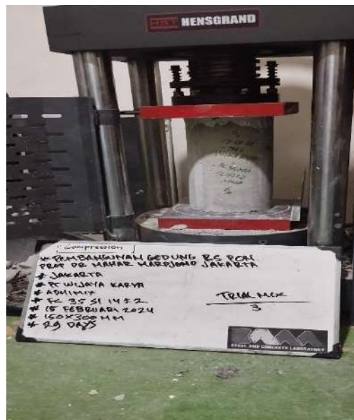
Gambar 5.4 Pengujian Kuat Tekan Beton
