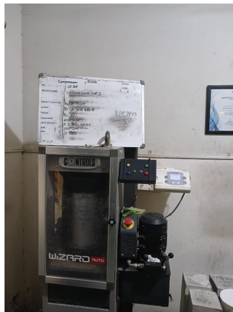
Gambar 5. 7 Test kuat tekan beton
