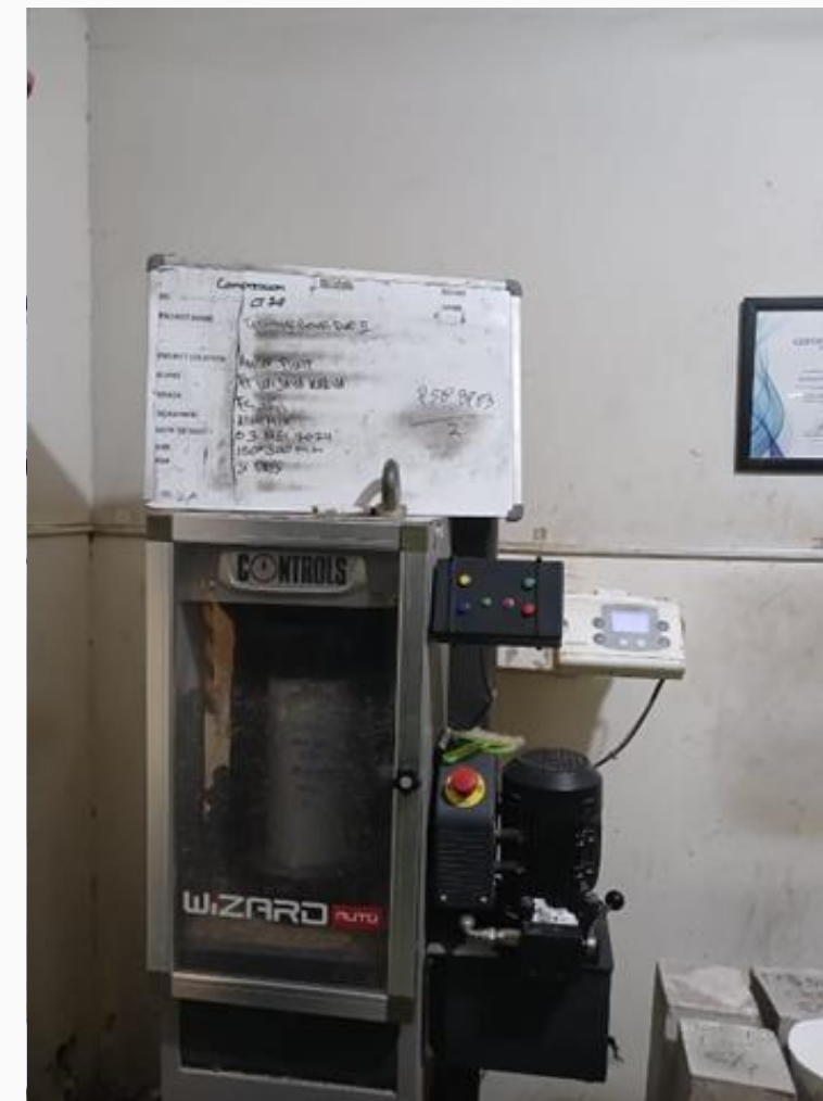
Test Kuat Tekan Beton
