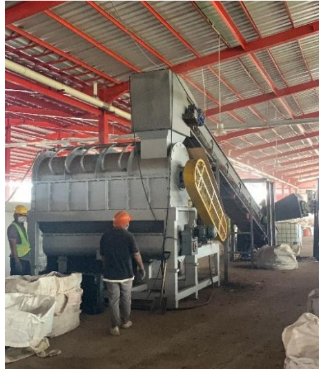
Gambar 2.3 Proses pengolahan sampah dengan mesin bubur
