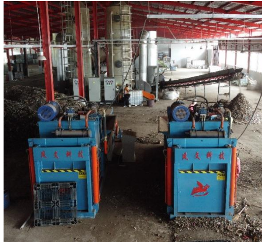
Gambar 2.12 Proses pencetakan sampah dengan mesin press
