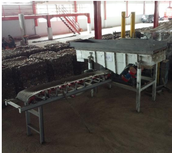
Gambar 2.11 Proses pemisahan sampah dengan mesin vibrate screener
