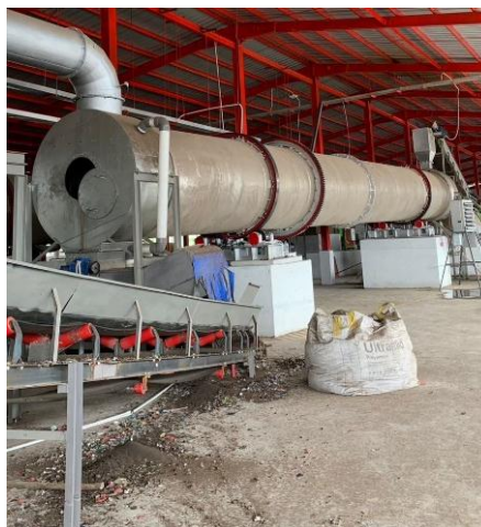
Gambar 2.10 Proses pengeringan sampah dengan mesin rotary dryer
