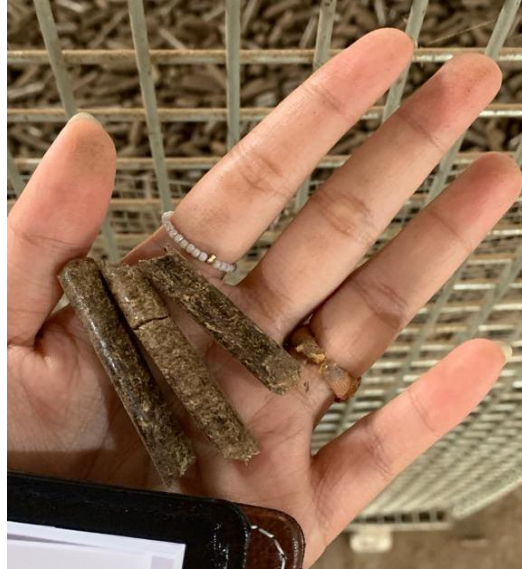
Gambar 2.17 Hasil proses percetakan menghasilkan Wood Pellet
