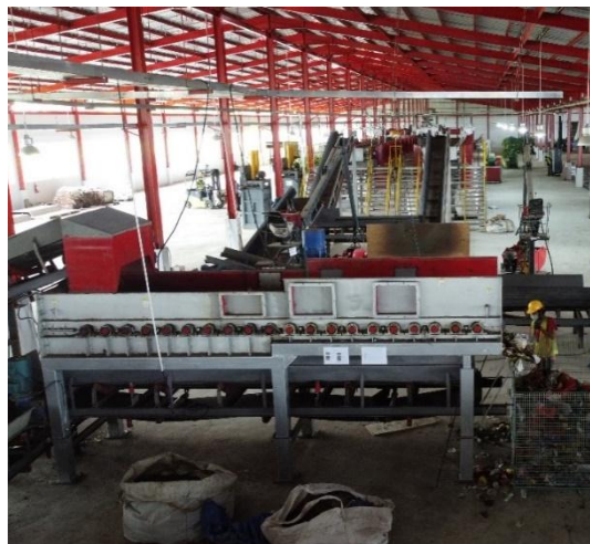
Gambar 2.4 Proses pemilahan menggunakan mesin disc screener
