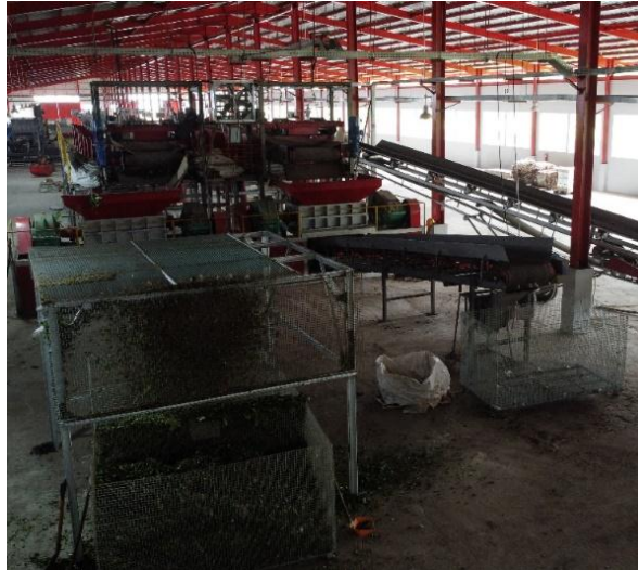
Gambar 2.7 Proses pencacahan sampah dengan mesin shredder
