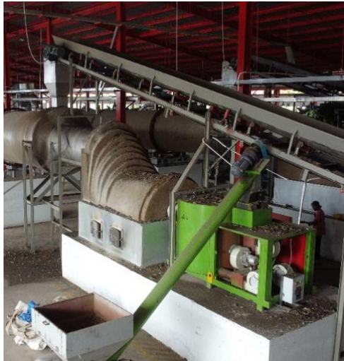
Gambar 2.9 Proses pembakaran sampah dengan mesin burnor
