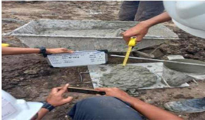
Gambar 5.8 Tes *slump* sebelum pengecoran
