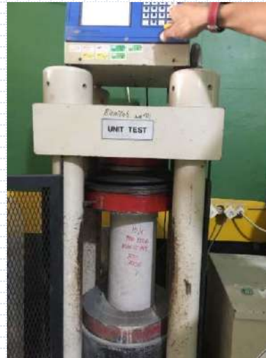
Uji Tekan Beton
